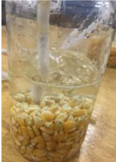
Figura 2 - Exposição das sementes submetidas a concentrações de gás ozônio diluído em água destilada, UNB, Brasília, DF, 2017.
