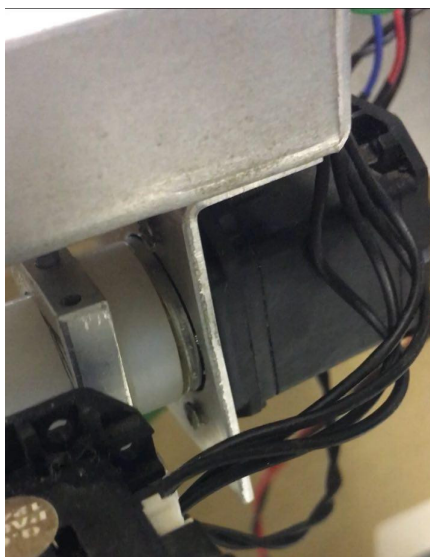
Figura 3.4: Conexão do servo com a estrutura de nylon na junta q_1
