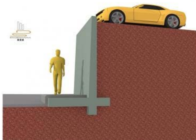
Figura 2.7 – muros de flexão.
