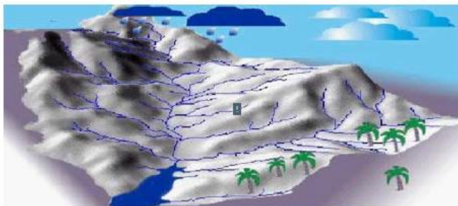
Figura 1 - Ilustração de uma bacia hidrográfica mostrando os divisores de água, as sub-bacias e a drenagem principal (SANTANA, 2003).
