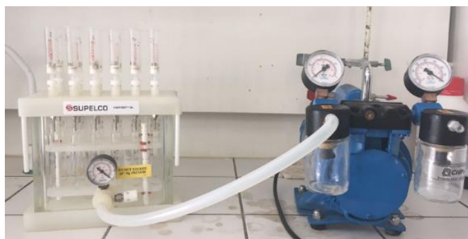
Figura 4.5 – Sistema de eluição com manifold à vácuo
