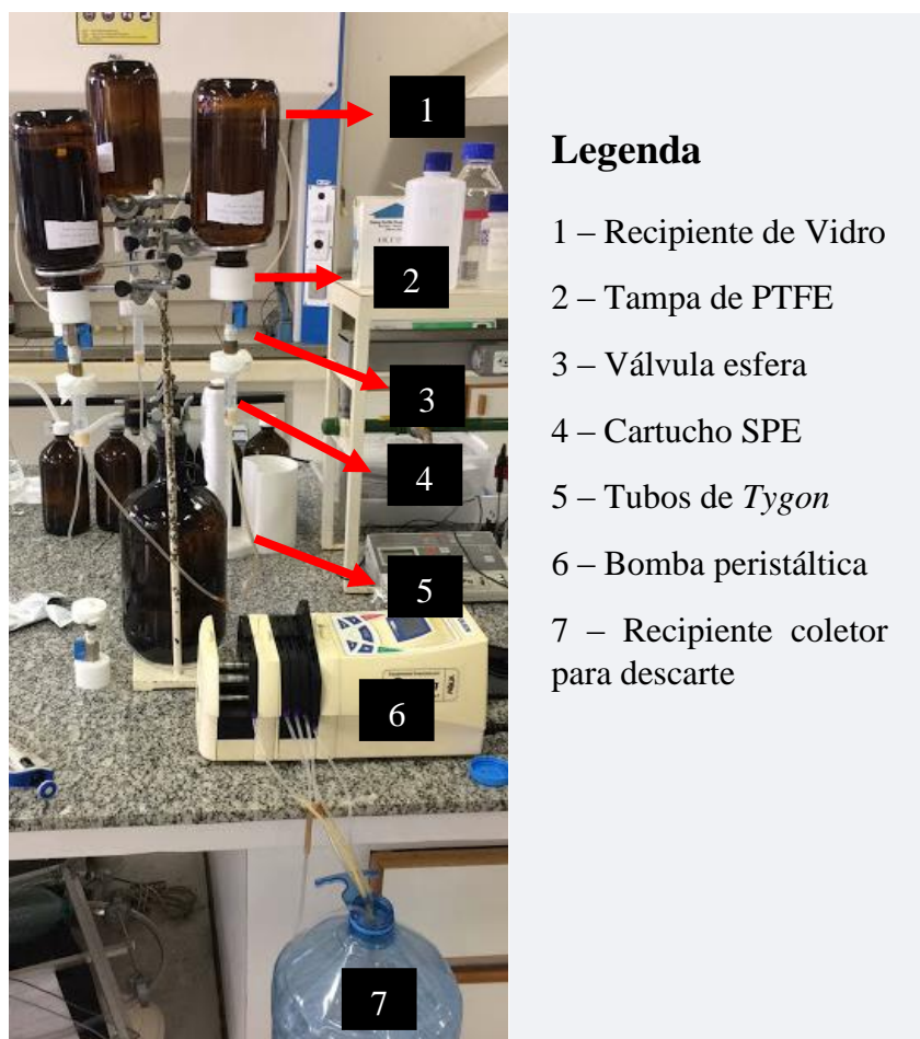
Figura 4.3 – Sistema de extra o para amostra de  gua do lago Parano 
