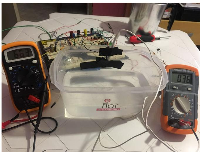
Figura 10 – Experimento realizado a fim de relacionar a mudança de temperatura à sua respectiva resistência, e assim adquirir uma curva que expressa o comportamento entre essas duas variáveis.
