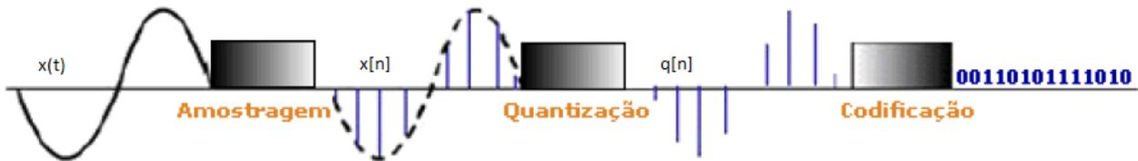
Figura 3 – Etapas da conversão A/D, onde  $x(t)$  é o sinal analógico;  $x[n]$  é o sinal discretizado no tempo, após o processo de amostragem;  $q[n]$  é o sinal quantizado; e ao final do processo de codificação, aparecem os *bits* correspondentes ao sinal analógico  $x(t)$ .
