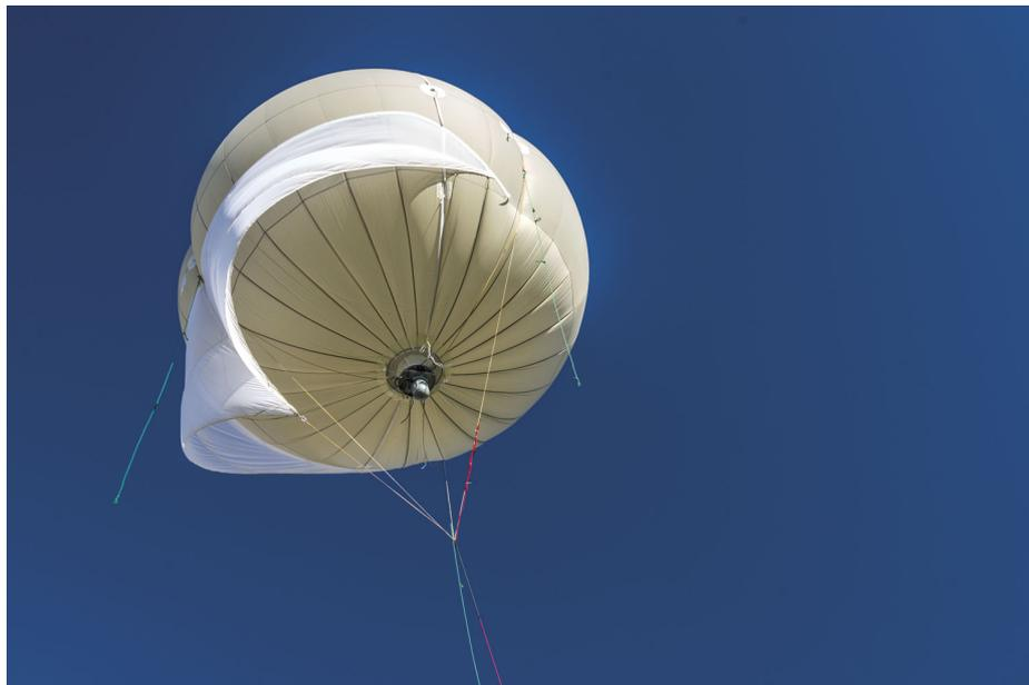
Figura 13 – Exemplo de balão meteorológico cativo. Fonte: [simi.org.br/noticia/Startup-construira-fabrica-de-baloes-cativos-em-Minas-Gerais](http://simi.org.br/noticia/Startup-construira-fabrica-de-baloes-cativos-em-Minas-Gerais)
