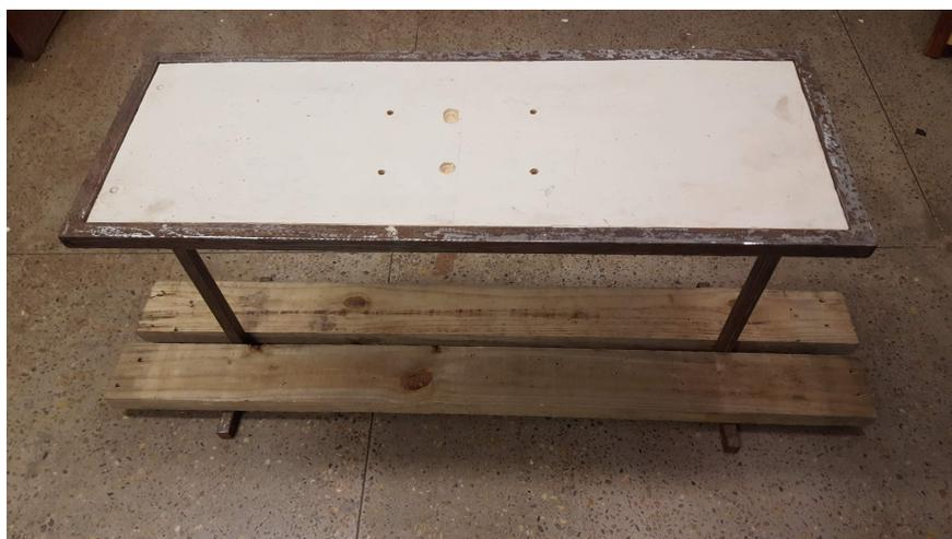
Figura 21 – Mesa de apoio do motor ancorada
