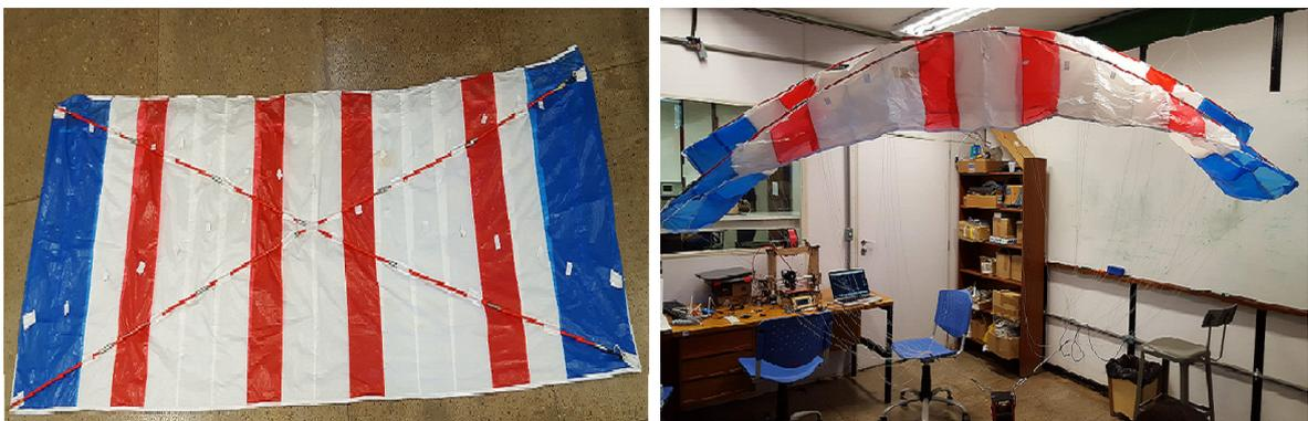
Figura 17 – Velame com a estrutura em "X"(a) deitada e (b) suspensa
