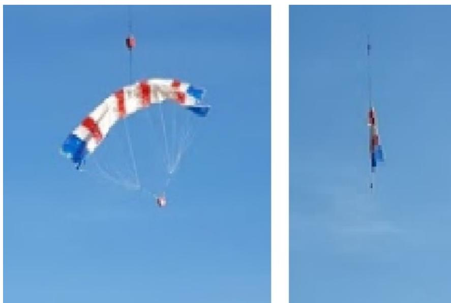
Figura 35 – Diferença de configuração do paraquedas (a) com e (b) sem as varetas estruturais
