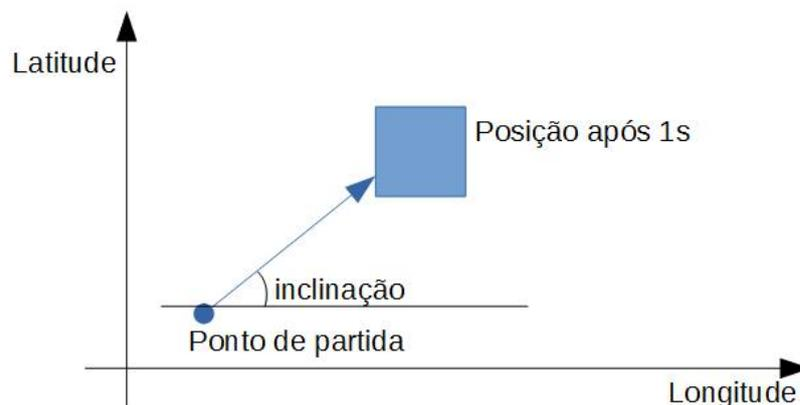
Figura 29: Método de calculo da inclinação da trajetória.
