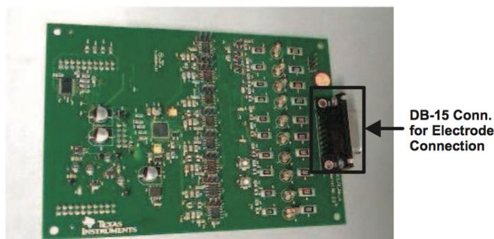
Figura 11 – Placa de *front-end* analógico para ECG Fonte: [Instruments \(1991\)](#)
