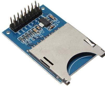
Figura 19 – Módulo de cartão SD Fonte: [INFINITO \(2017\)](#)
