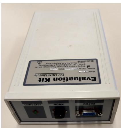
Figura 13 – Módulo de funções do kit multiparamétrico CSN 808
