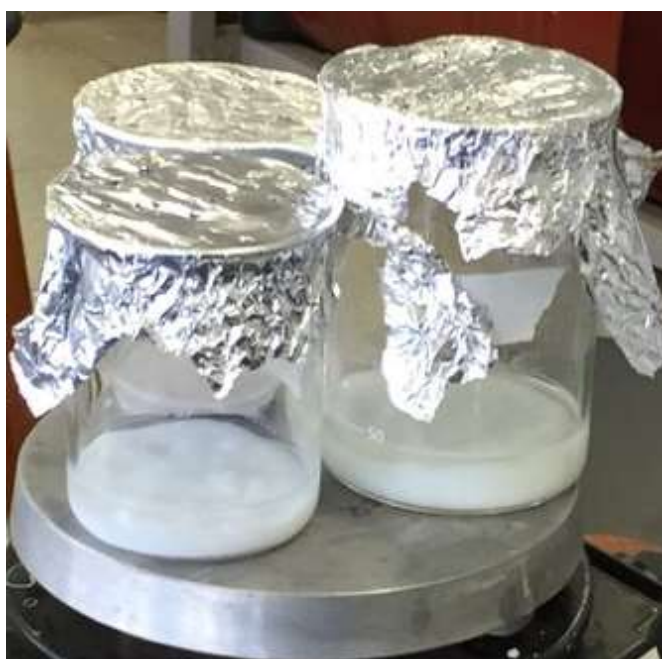
Figura 4.3 – Material Precipitado em Processo de Secagem
