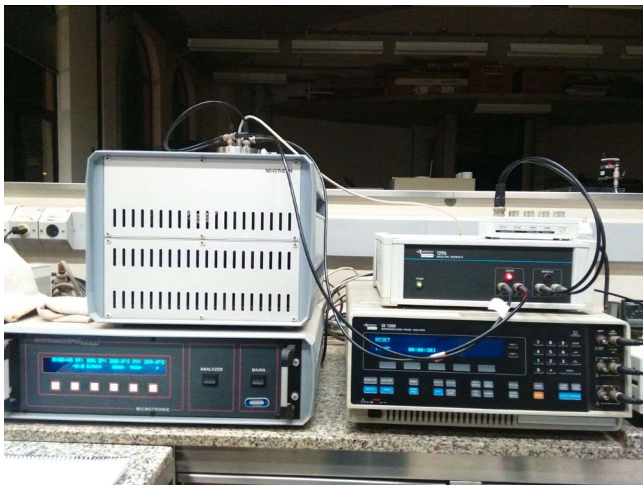
Figura 4.9 – Equipamento Solartron 1260 utilizado na espectroscopia de impedância
