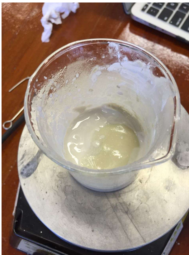
Figura 4.4 – Resina Polimérica do Método Pechini de Síntese
