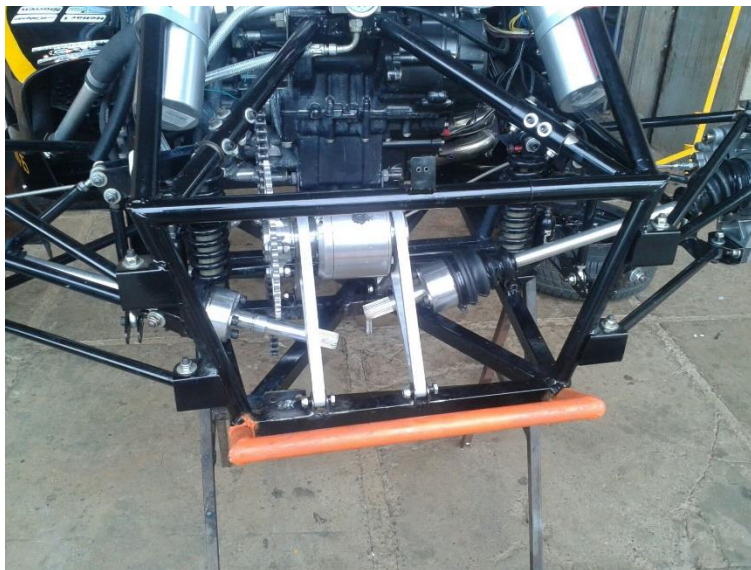
Figura 3-7: Diferencial montado no veículo AF15
