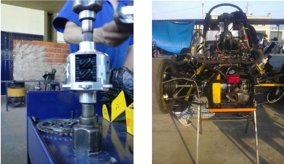
Figura 3-3: (a) Diferencial T-1 modificado; (b) AF14 na FSAE Brasil 2014.
