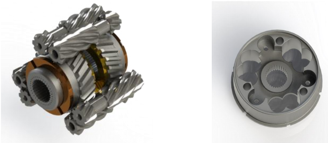
Figura 5-5: Engrenamento e carcaça do T-2 – (a) e (b).
