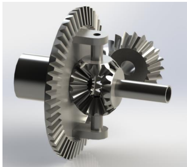
Figura 2-1: Engrenagens do diferencial convencional [23].
