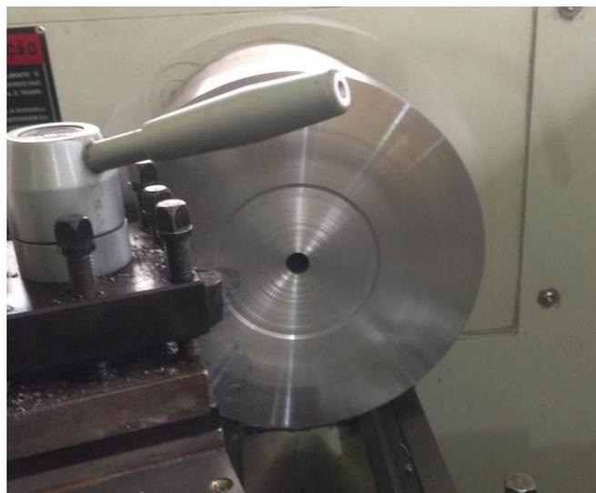
Figura 27. Faceamento rápido a seco (Fonte: Autores, 2017).
