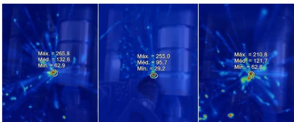
Figura 54. Medições de temperaturas na ponta da ferramenta no torneamento cilíndrico externo do ferro fundido (Fonte: Autores, 2017).
