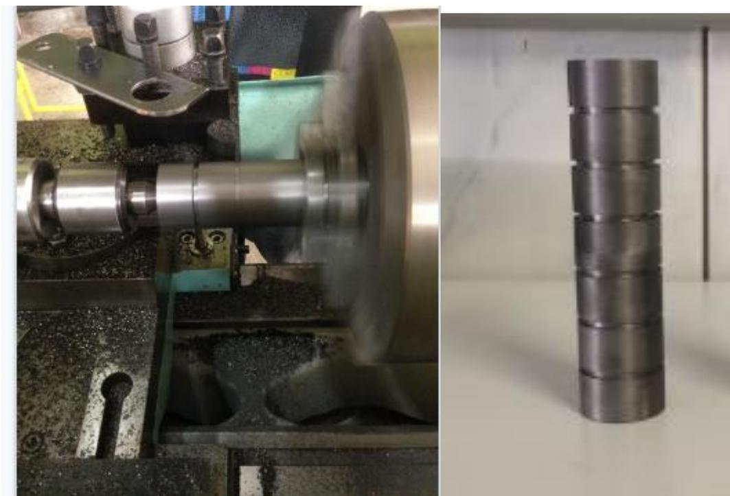
Figura 37. Preparação do corpo de prova de ferro fundido (Fonte: Autores, 2017).
