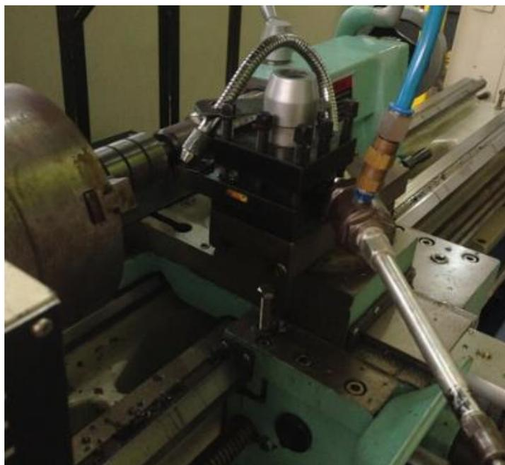
Figura 35. Torneamento cilíndrico externo com tubo vórtices aço SAE 1045 (Fonte: Autores, 2017).
