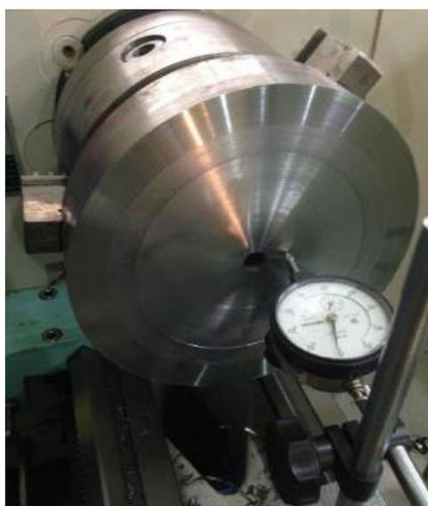
Figura 30. Montagem do relógio comparador para medição do ressalto formado (Fonte: Autores, 2017).
