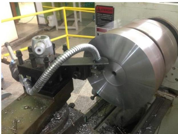
Figura 29. Faceamento rápido com utilização do Tubo Vórtices (Fonte: Autores, 2017).
