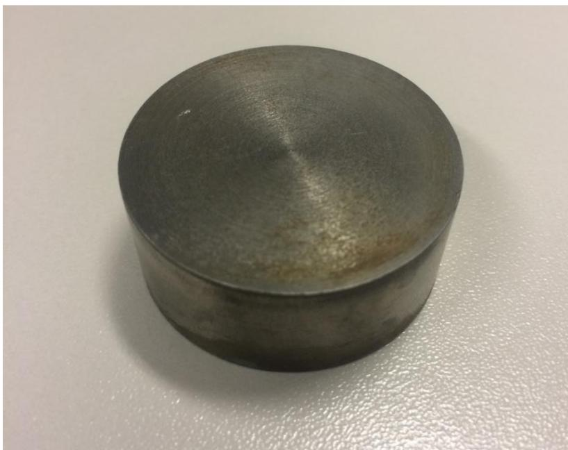
Figura 41. Corpo de prova para ensaio de metalografia (Fonte: Autores, 2017).
