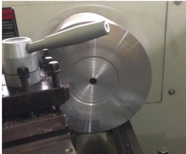
**Figura 4. Faceamento rápido a seco.**
