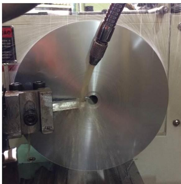
Figura 28. Faceamento rápido com jorro de fluido de corte (Fonte: Autores, 2017).
