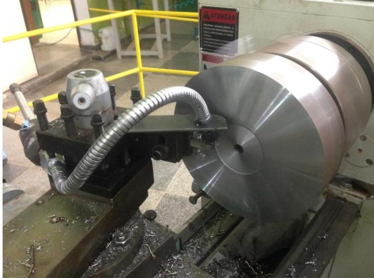
**Figura 6. Faceamento rápido com utilização do Tubo Vórtices.**
