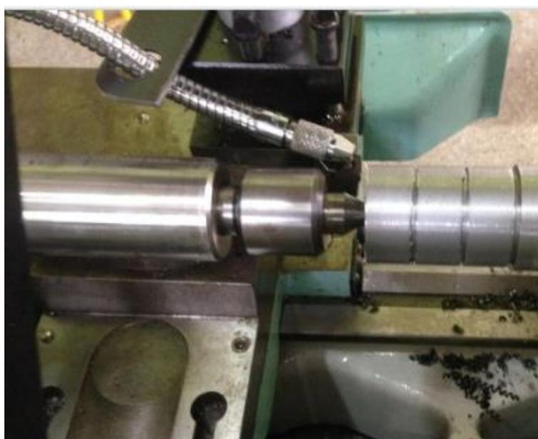
Figura 34. Torneamento cilíndrico externo com jorro aço SAE 1045 (Fonte: Autores, 2017).
