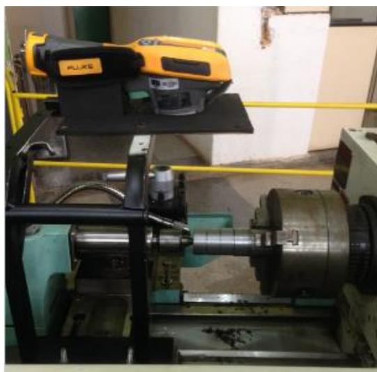
Figura 31. Posicionamento da Câmera Térmica no torno (Fonte: Autores, 2017).
