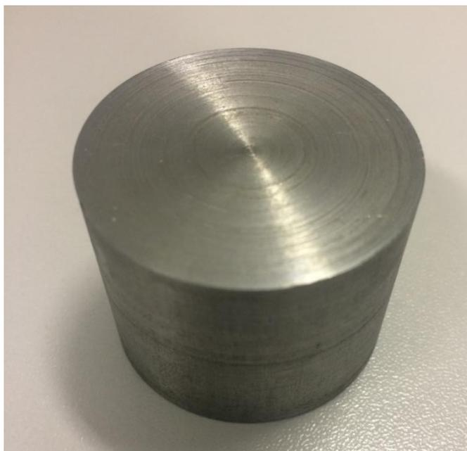
Figura 42. Corpo de prova para ensaio de metalografia do aço SAE 1045 (Fonte: Autores, 2017).
