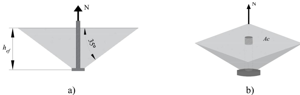
Figura 10 – Ruptura do cone de concreto de acordo com o método CCD – Costa (2016)
