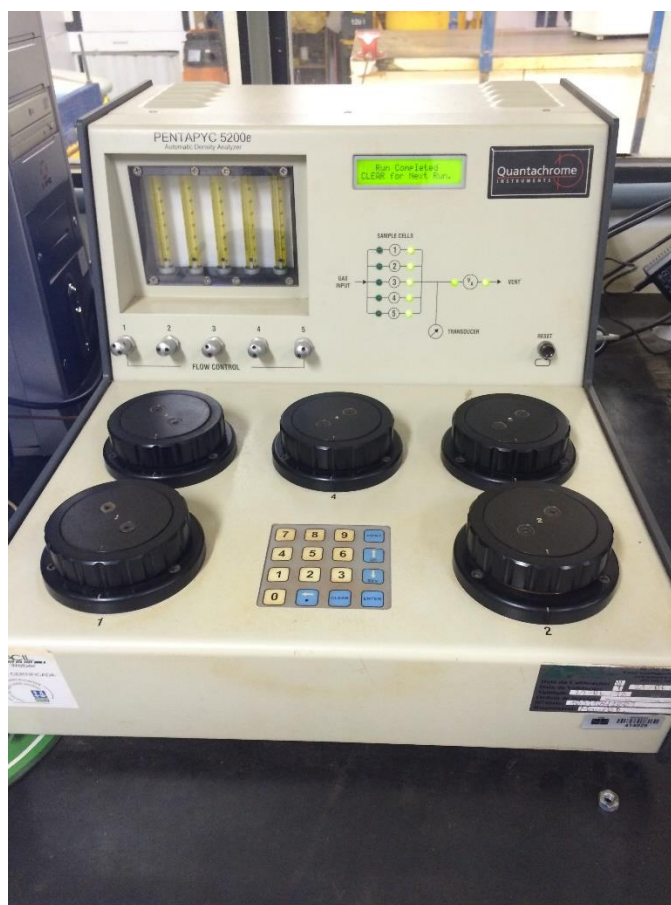
Figura 3.4 – Pentapicnômetro - aparelho que realiza a medida da densidade específica dos grãos de forma automatizada e que não necessita de água para tal sendo ideal para materiais expansivos. (Fonte: Acervo Pessoal)
