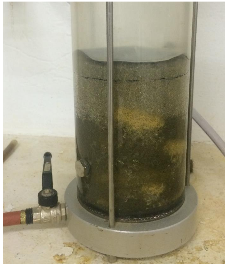
Figura 4.3– C.P. depois de adensado por mais de 24h. Nota-se na diferença de coloração da areia a absorção de água. Além disso, a diferença de altura do C.P., visto que os 15 cm se situam na linha preta marcada no cilindro (Fonte: Acervo Pessoal).
