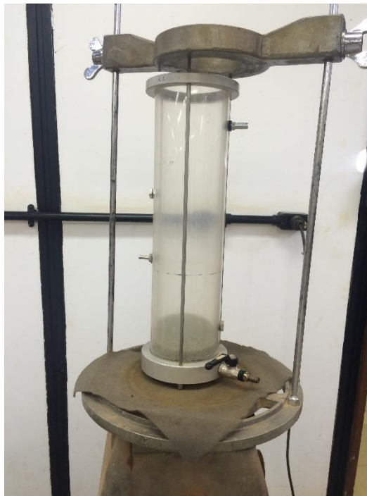
Figura 4.2 – Permeâmetro preso ao agitador mecânico para vibrar (Fonte: Acervo Pessoal).
