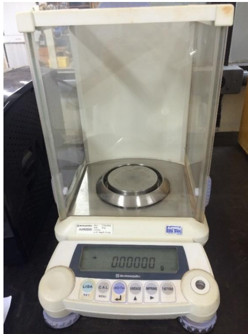
Figura 3.6 – Balança de alta precisão - utiliza 5 casas decimais, utilizada no ensaio para determinação do Gs da bentonita. (Fonte: Acervo Pessoal)
