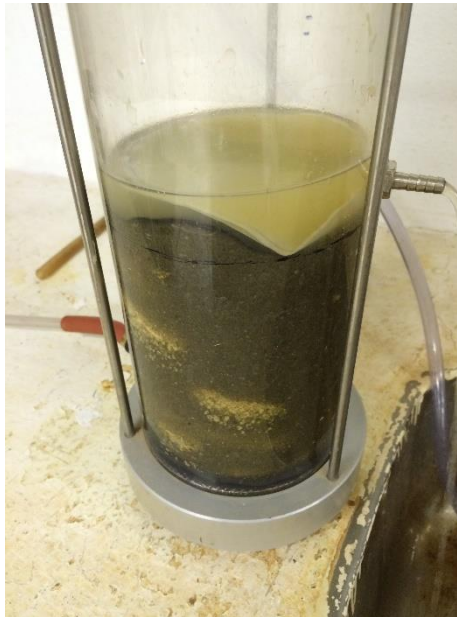
Figura 3.9 – Arraste de partículas - Experimento em que o material foi colocado seco na célula do permeâmetros e posteriormente saturado com o gradiente mínimo que o aparato experimental permite ocorrendo o arraste dos finos (Fonte: Acervo Pessoal).
