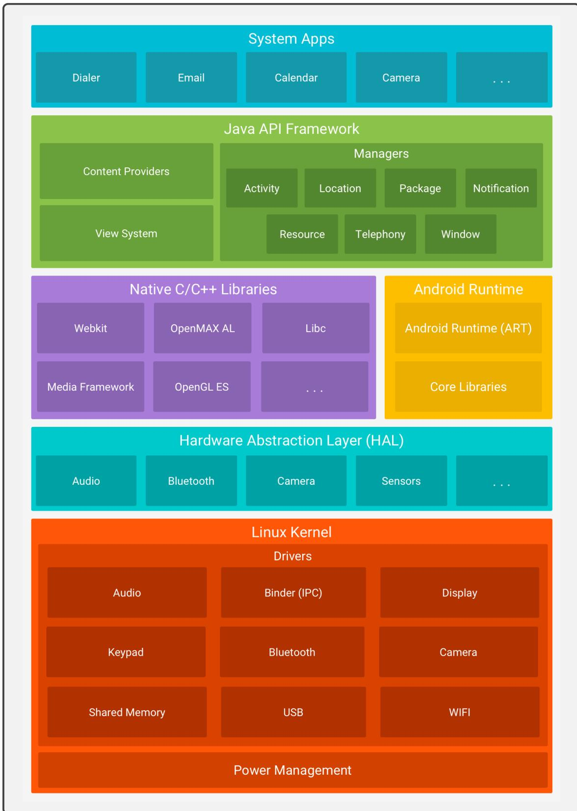
Figura 3.3: Pilha de Software do Android ([24]).
