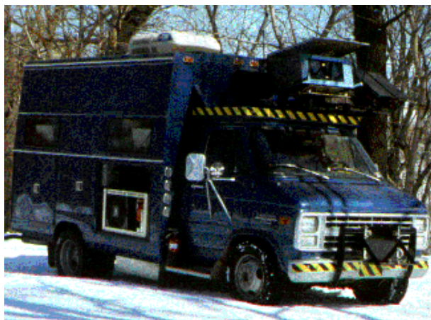
Figura 4.3: NAVLAB: o veículo autônomo de testes da rede neural artificial ALVINN. 3
