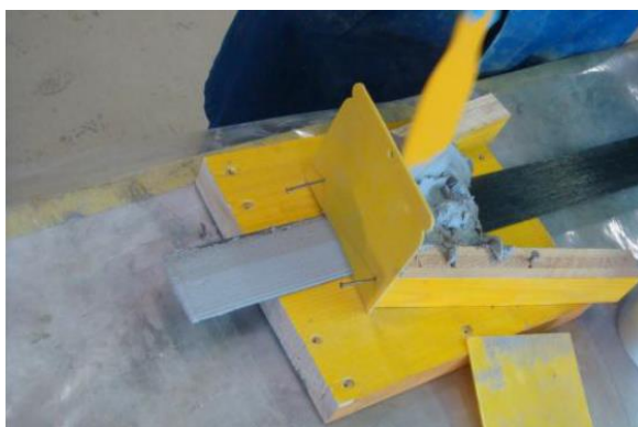
Figura 2.6 - Ferramenta para aplicação de adesivo sobre lâmina
