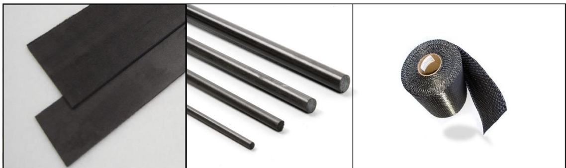
Figura 2.3 - Lâminas, barras e tecido de PRFC
