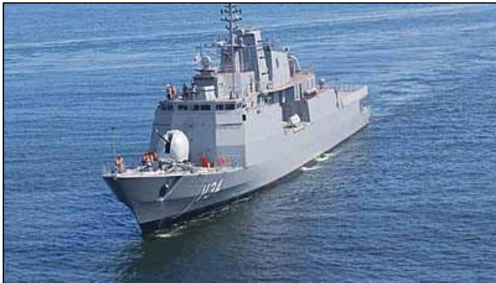
Figura 4: Corveta “Barroso”, 103,5m de comprimento e deslocamento de 2400 ton (plena carga).
