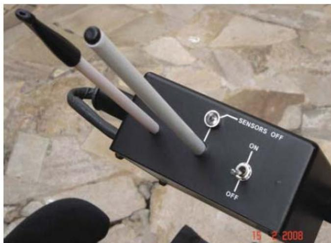
**Figura 12 - Interface de controle por sopro e sucção utilizado em [20]**
