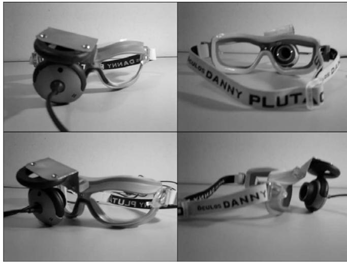
**Figura 8 - Câmera montada sob óculos de proteção para interface baseada em VOG [16]**
