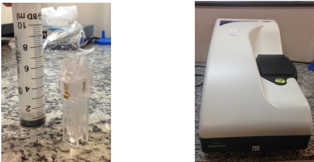
Figura 3-2: Na esquerda: célula DTS1060C utilizada no ensaio de Potencial Zeta. Na direita: aparelho para medição do Potencial Zeta
