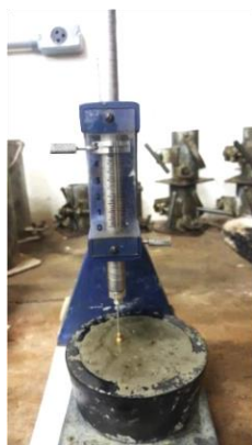
Figura 4-8: Aparelho de Vicat utilizado na Determinação do tempo de fim de pega
