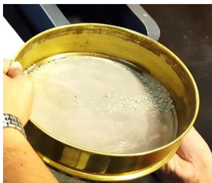
Figura 4-10: Peneira de abertura 75 \mu\text{m} utilizada (n° 200)
