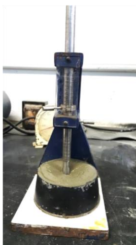
Figura 4-7: Aparelho de Vicat para determinação da pasta de consistência normal
