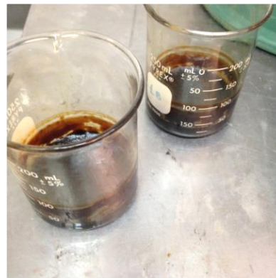
Figura 4-1: Amostras de superplastificante com nanossílica estabilizada, antes (à esquerda) e depois (à direita) da secagem
