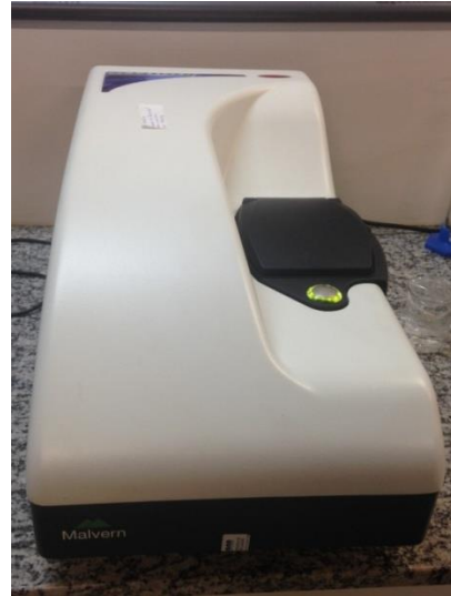
Figura II-2: Na esquerda: célula DTS1060C utilizada no ensaio de Potencial Zeta. Na direita: aparelho para medição do Potencial Zeta
