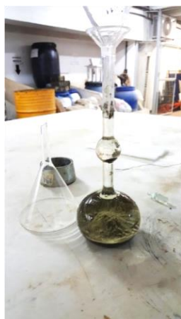
Figura 4-9: Aparelho utilizado na determinação da massa específica do cimento
