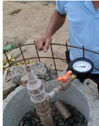
Figura 4.19 – Detalhamento da extremidade superior do piezômetro do tipo sifão instalado em aterro no Rio de Janeiro (SCHULER, 2010).
