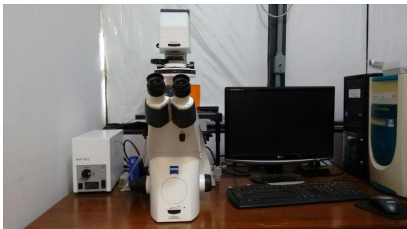
Figura 4.9 – Microscópio invertido Axio Observer A.1 da marca Carl Zeiss, LSA/UnB.
