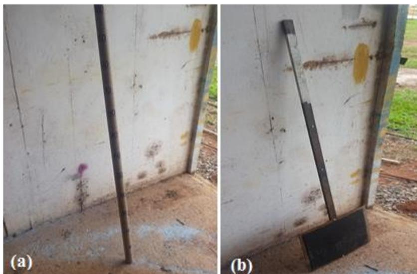
Figura 4.7 - Instrumentos para medição de vazão: (a) Régua confeccionada em tubo PVC e (b) Ferramenta para tampar tubulação.
