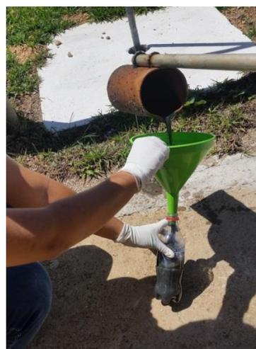
Figura 4.5 - Coleta de lodo utilizando garrafa PET
