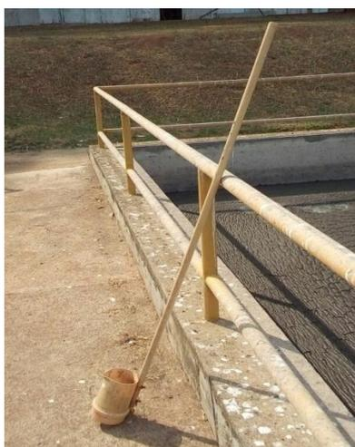
Figura 4.4 - Coletor utilizado nos pontos (2), (3) e (4)
