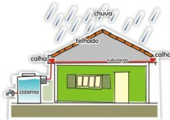
Figura 5: Esquema de um sistema de captação de água de chuva. Fonte: ROTARY CLUB 2015.
