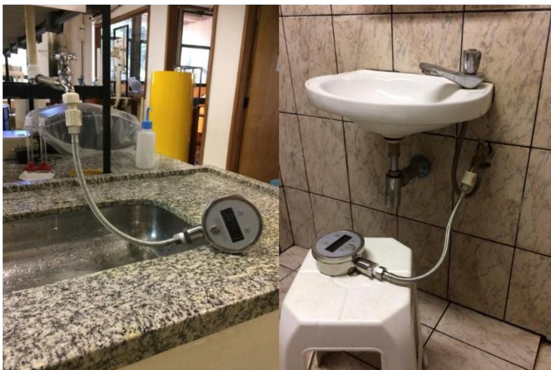
Figura 5.4- Localização das instalações de manômetros no SG12 e FT
