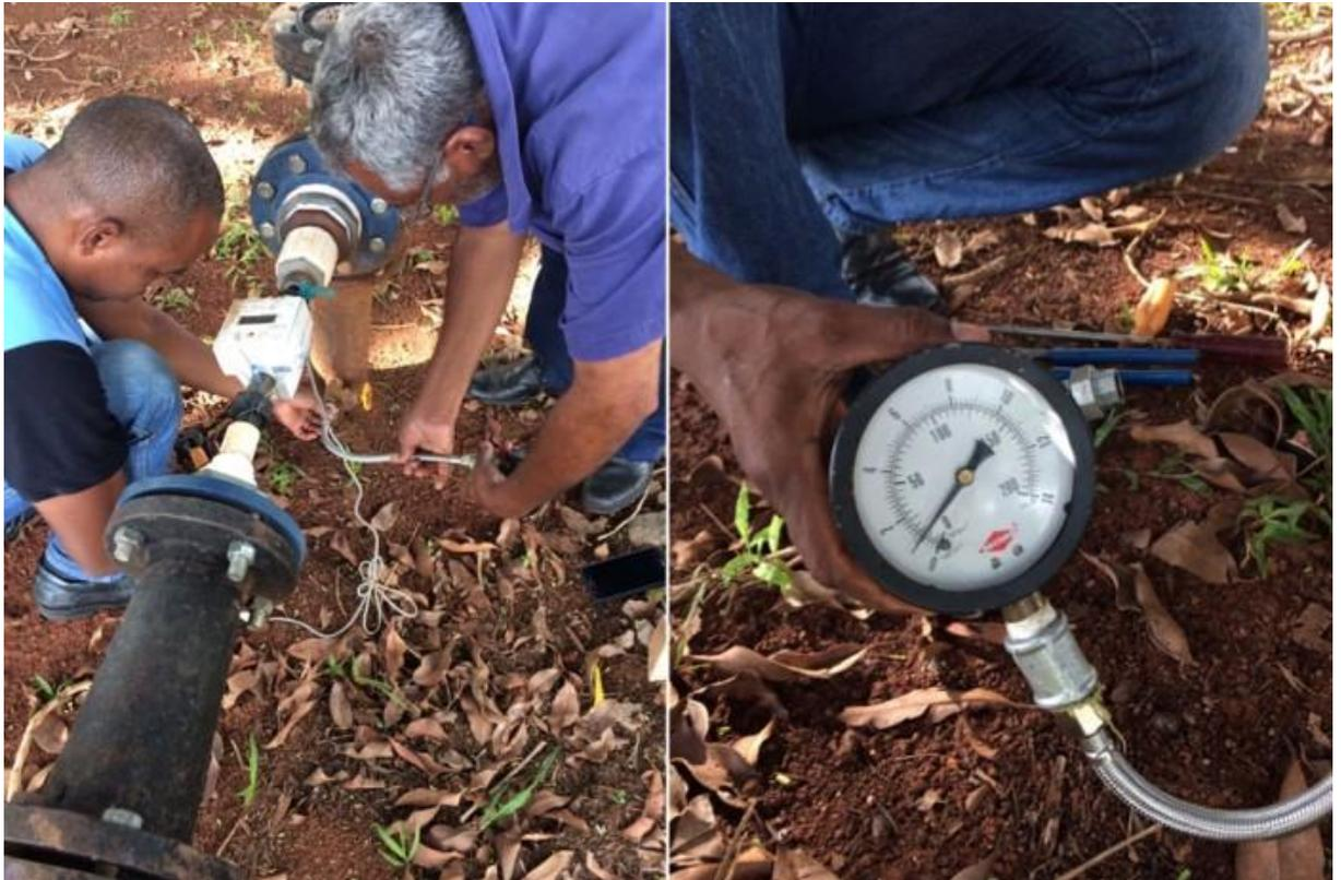
*Figura 6.4- Verificação de pressão junto a FT realizada pelos técnicos da PRC*
