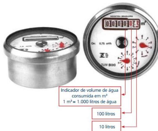
Figura 3.7- Leitura de hidrômetro. (Fonte: SABESP, 2009)
