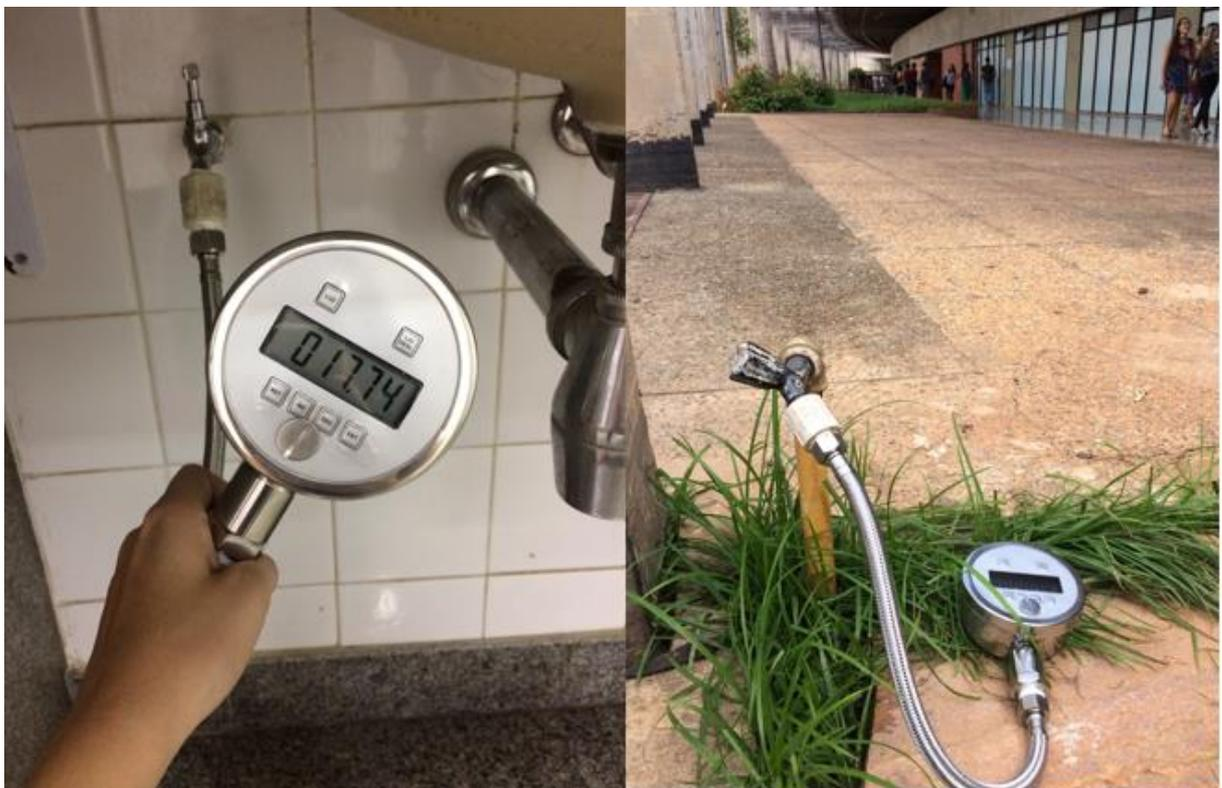
*Figura 5.7- Localização das instalações de manômetros no ICC norte e sul*
