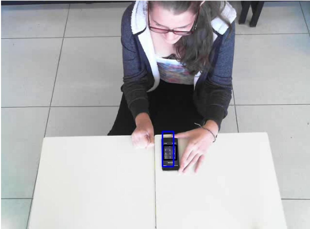
Figura 3.6: *Frame* da gravação original com o teclado delimitado em preto, desenhado manualmente, e a estimação da localização do teclado, realizado pelo algoritmo, em azul.
