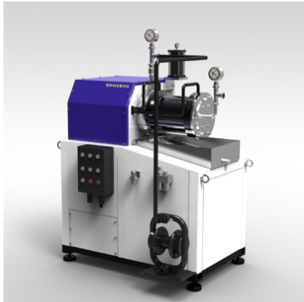
Figura 14 - Moinho horizontal de discos modelo SWS-20 da marca Sower.
