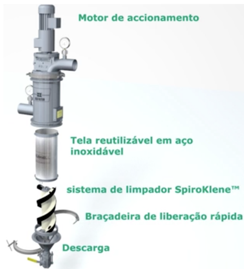
Figura 19 – Interior do filtro autolimpante Russell Eco Filter da Russell Finex.
