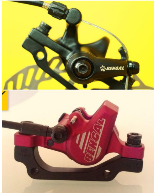
Figura 27 – Pinças de freio de bicicleta. O modelo superior usa acionamento mecânico e o inferior acionamento hidráulico (29).
