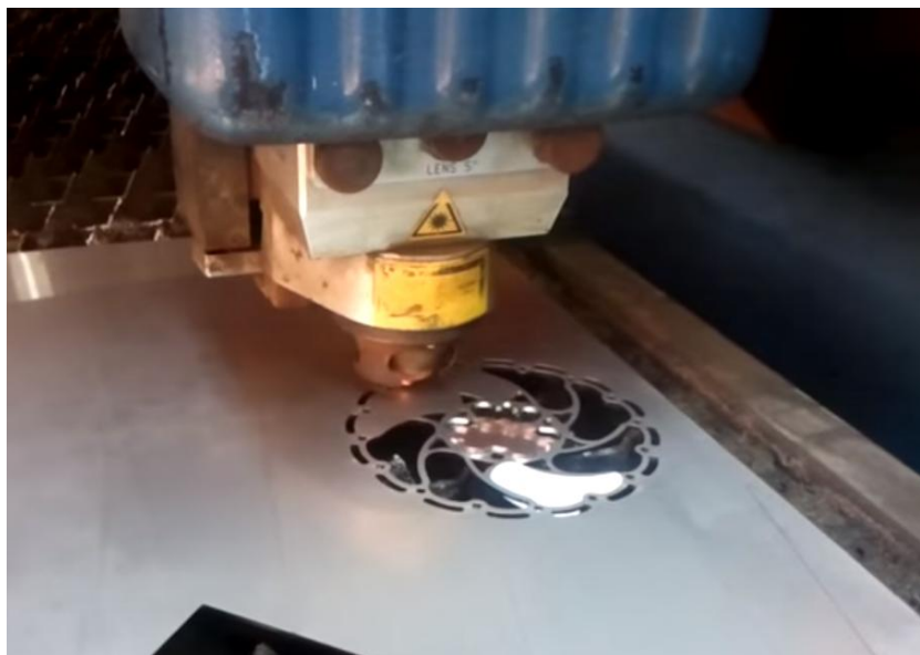
Figura 26 – Máquina de corte a laser cortando um disco de freio para bicicleta (21).
