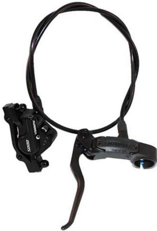
Figura 5 – Sistema hidráulico de freio para bicicleta, contendo manopla, pinça e tubos (26).
