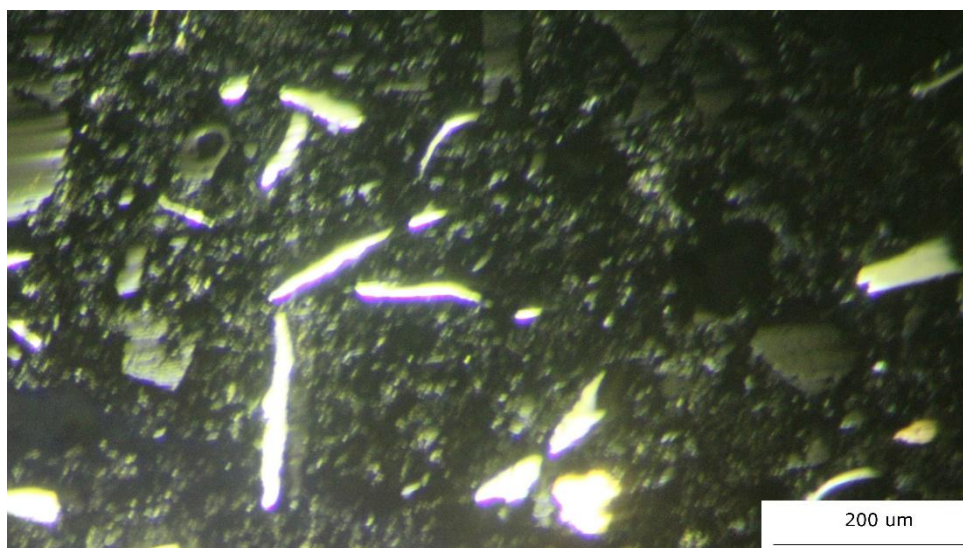
Figura 44 – Superfície polida da pastilha aumento 100x (Autor).
