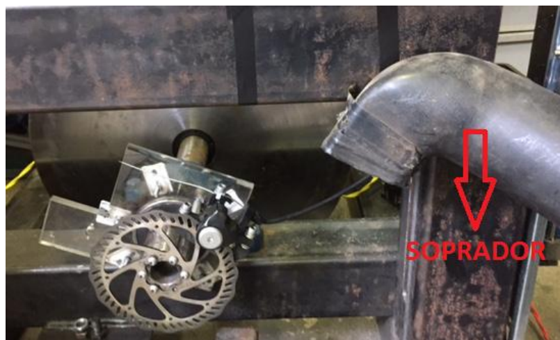
Figura 42 – Soprador montado na bancada (Autor).
