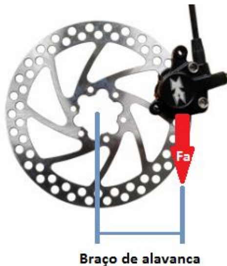
Figura 14 – Força de atrito e braço de alavanca em um disco de freio de bicicleta (Autor).
