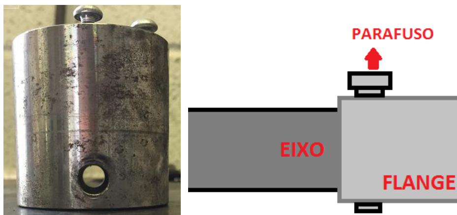
Figura 30 – Flange com furo passante e esquemático da flange instalada (Autor).
