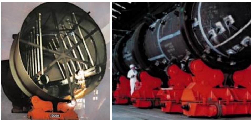
Figuras 2.29 e 2.30. BODE rotacionadores autoalinháveis – SAR 2000 e SAR 5000 [16]
