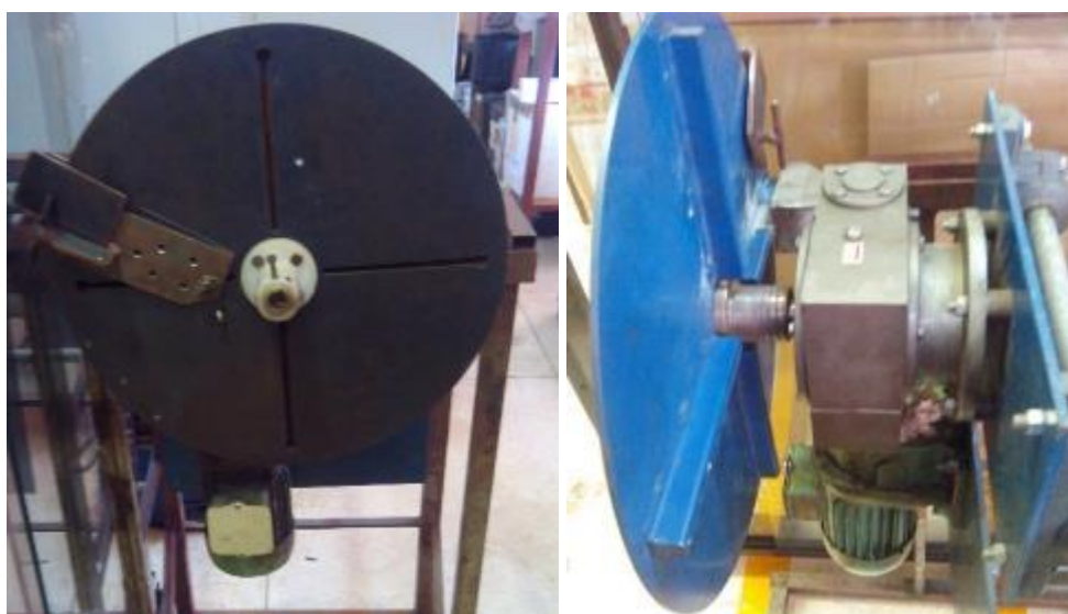
Figura 4.5. Disco de Fixação de frente e conexão com a caixa de redução.
