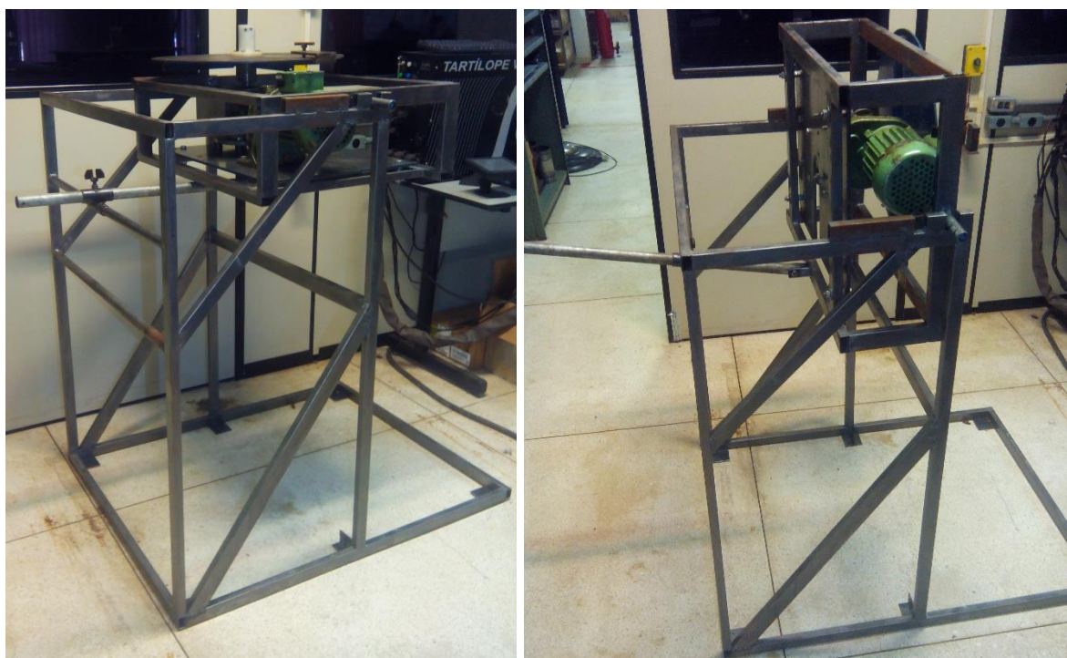
Figuras 5.4 e 5.5. Sistema de Fixação – Posição de Estabilidade e Posição de Trabalho.
