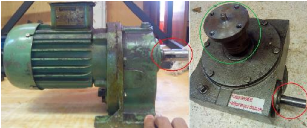
Figura 4.1. Motor e Caixa de Redução do Disco de Sustentação
