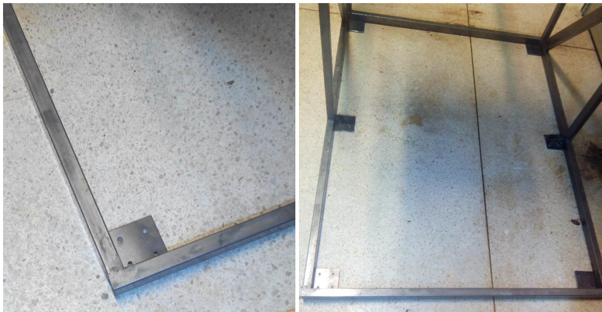
Figuras 5.2 e 5.3. Sistema de Fixação – Chapa de Fixação e Parte Inferior da Base.
