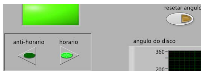
Figuras 5.6. Novo Painel Frontal – Detalhe de Sentido de Rotação e Botão de Reset.
