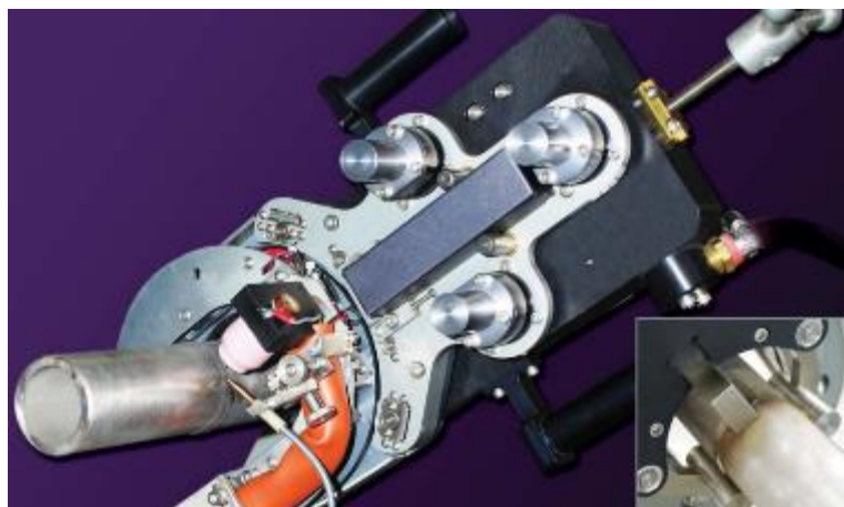
Figura 2.41. Liburdi Dimetrics cabeça de soldagem [22]
