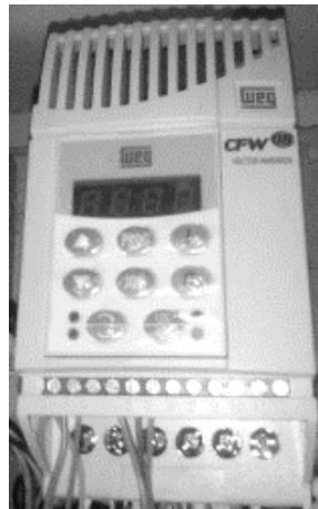
Figura 4.3. Inversor de Frequência CFW 08 da WEG
