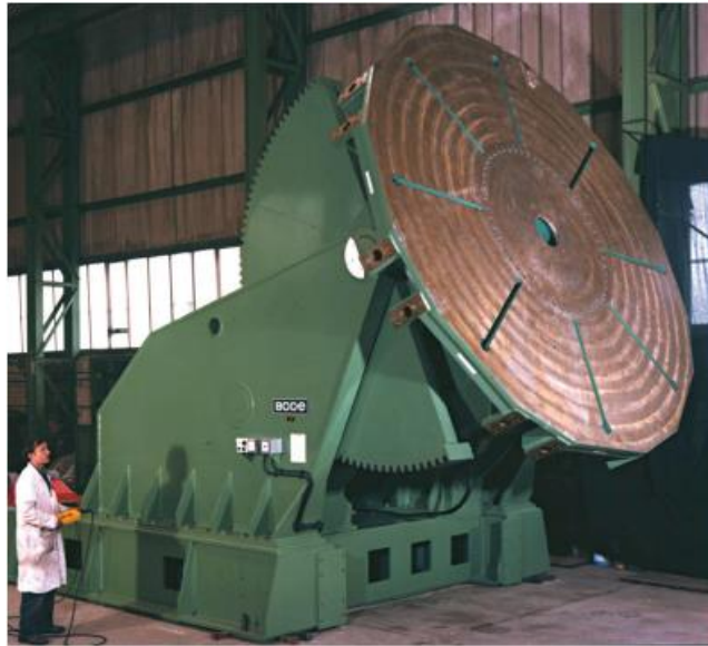
Figura 2.38. BODE Posicionador Especial – VP.100 [19]
