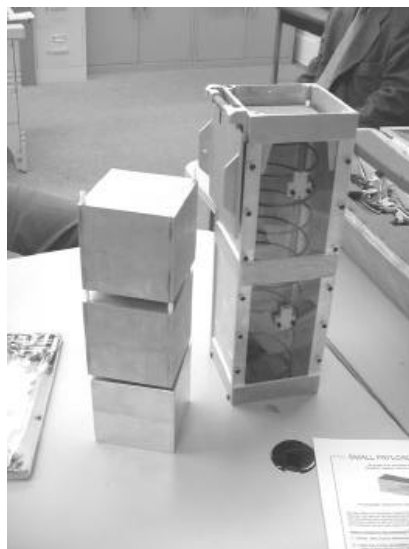
Figura 3 - Primeiro protótipo de um CubeSat mais lançador [13]
