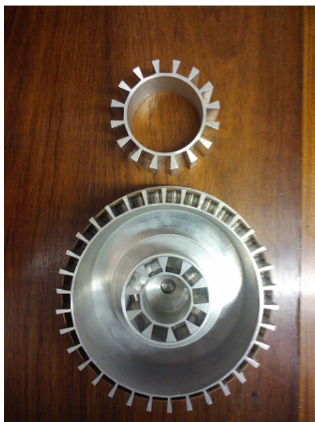
Figura 1.3: Propulsor PHALL-2 com canal de aceleração e compartimento para ímãs.
