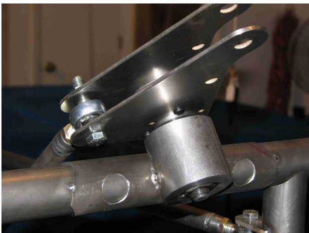
Figura 23. Sistema com rocker arm em detalhe. Fonte: http://www.atomictoyshop.com/A-Arms3.htm
