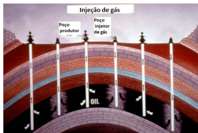
Figura 2.13 Método convencional de recuperação secundária por injeção de gás imiscível (modificada Almeida, 2004).
