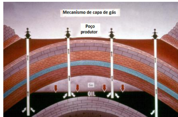
Figura 2.10 Recuperação primária por mecanismo de capa de gás (modificada Almeida, 2004)
