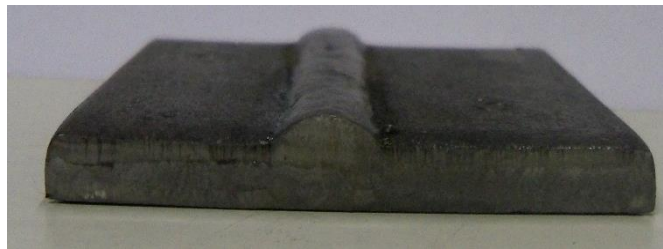
Figura 4.9 Seção do corpo de prova 22 antes do polimento.
