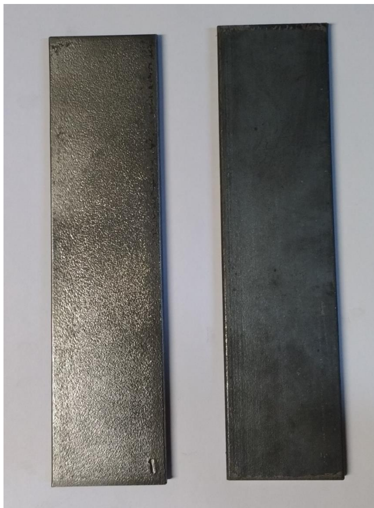
Figura 4.1 Corpo de prova nº 1 - 200x50,8x6,35mm.
