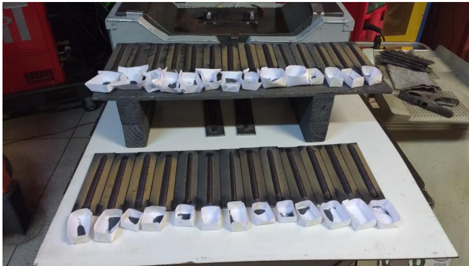
Figura 4.5 Corpos de prova com respingos recolhidos.
