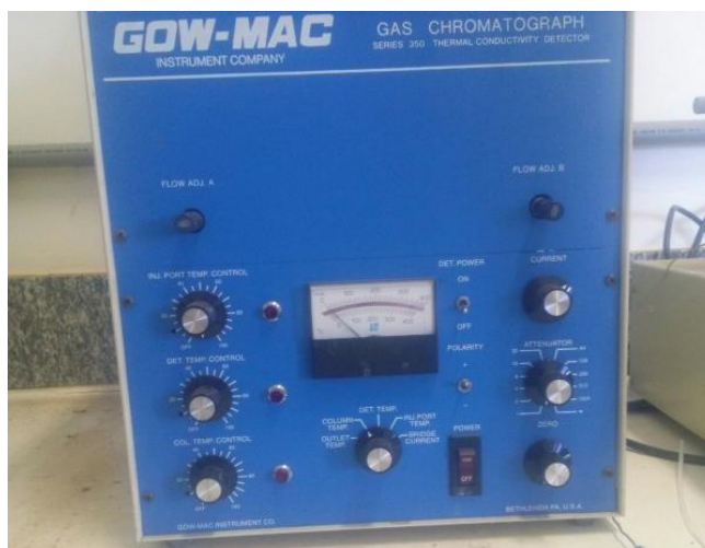
Figura 8: Forno cromatográfico utilizado como área de troca térmica do reator.
