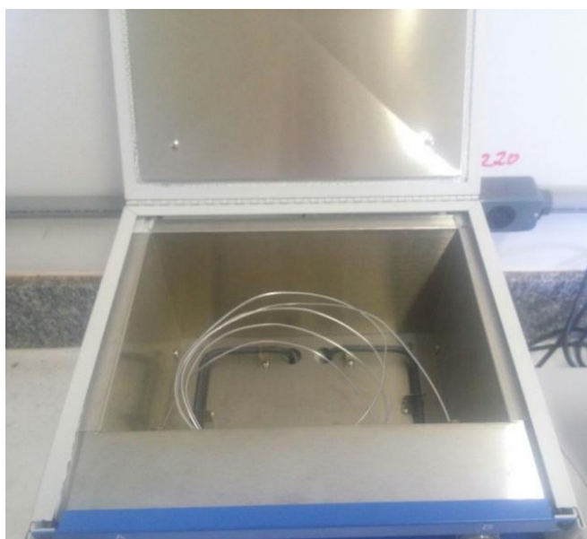
Figura 9: Disposição do tubo reacional dentro do forno cromatográfico.
