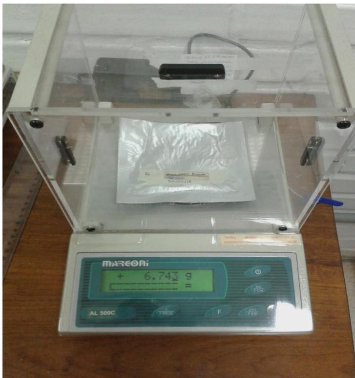
**Figura 4:** Balança de precisão utilizada para a pesagem das sementes de *Pterogyne nitens* Tul.
