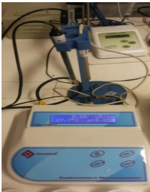
Figura 8: Condutímetro de bancada empregado no teste condutividade das sementes de Eugenia dysenterica .
