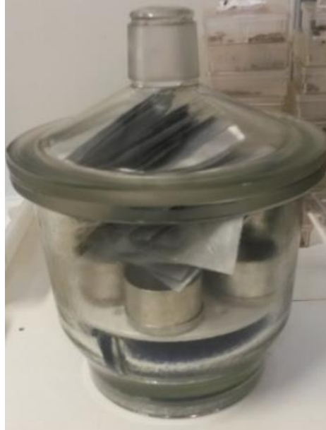
Figura 7: Dessecador com as amostras de sementes de Eugenia dysenterica submetidas a secagem em estufa a 105°C.
