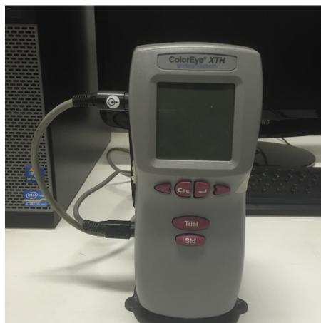
Figura 6 - Espectrofotômetro Color Eye XTH - X-Rite.
