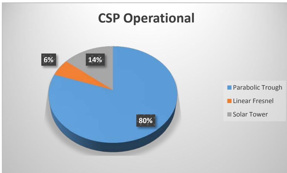
Figura 1.3 Tipos de tecnologia das plantas heliotérmicas em operação. Elaboração própria. Fonte de dados: CSPToday. Cilindro parabólico (azul) – 4331,09 MW. Linear Fresnel (laranja) – 296,94 MW. Torre Solar (cinza) – 761,1 MW.
