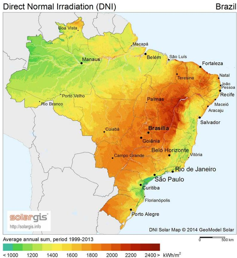
Figura 2.4 Índices de radiação direta para o Brasil. Fonte: SolarGIS.
