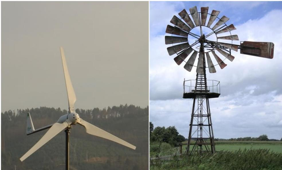
Figura 2.1: Turbinas eólicas com três e dezoito pás
