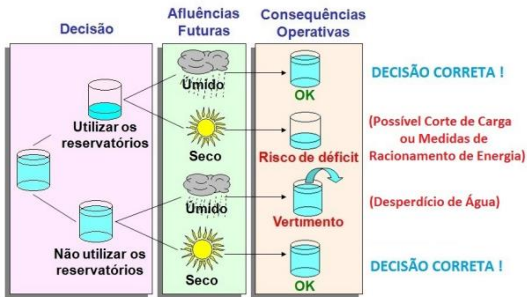
Figura 1.4 Dilema do Operador Nacional do Sistema Elétrico
