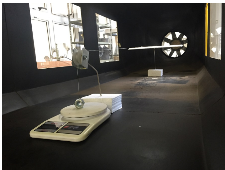
Figura 30 – Sistema de balança para medição da força de arrasto. Fonte: do autor (2015).
