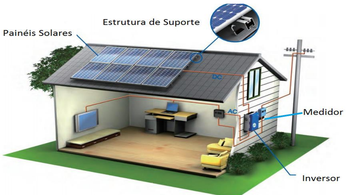
Figura 4. Elementos Elétricos necessários para instalação de Sistemas Fotovoltaicos. Fonte: Adaptação de figura presente em _____. http://solvenergia.blogspot.com.br , acesso em 10 de novembro de 2014.
