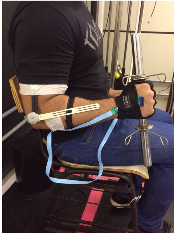
Figure 7 – Coleta de dados comparativos, entre o sistema implementado e eletrogoniômetro
