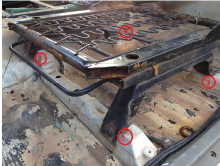
Figura 63. Locais de fixação do componente de ancoragem junto ao assoalho do veículo.
