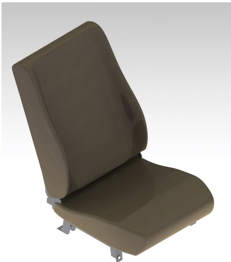
Figura 36. Modelo CAD: Banco veicular completo.
