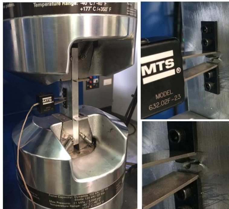
Figura 28- Corpo de prova montado com clip-on gage posicionado
