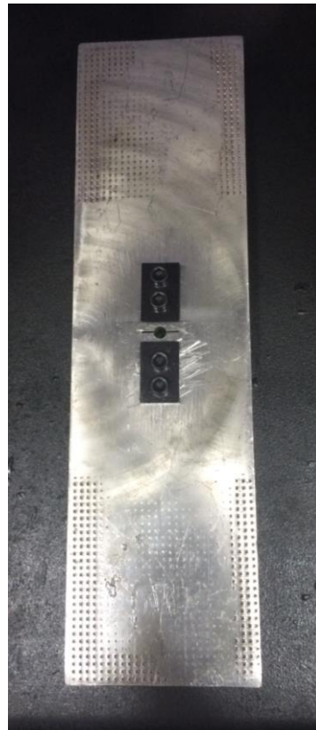
Figura 27- Corpo de prova com peças de fixação do clip-on gage aparafusadas
