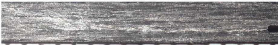
Figura 3- Crescimento característico da trinca na direção T-L
