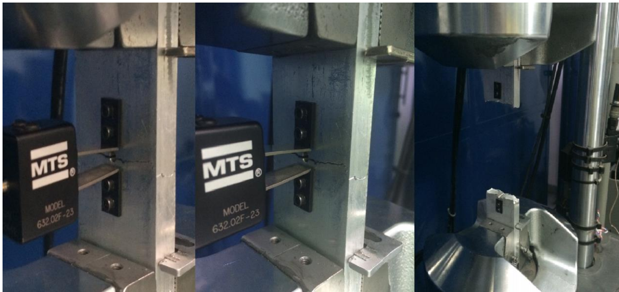
Figura 32- Desenvolvimento da trinca do corpo de prova 2
