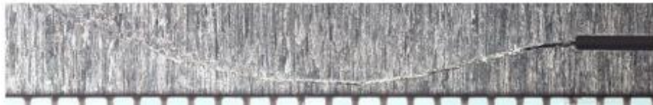
Figura 2- Crescimento característico da trinca na direção L-T
