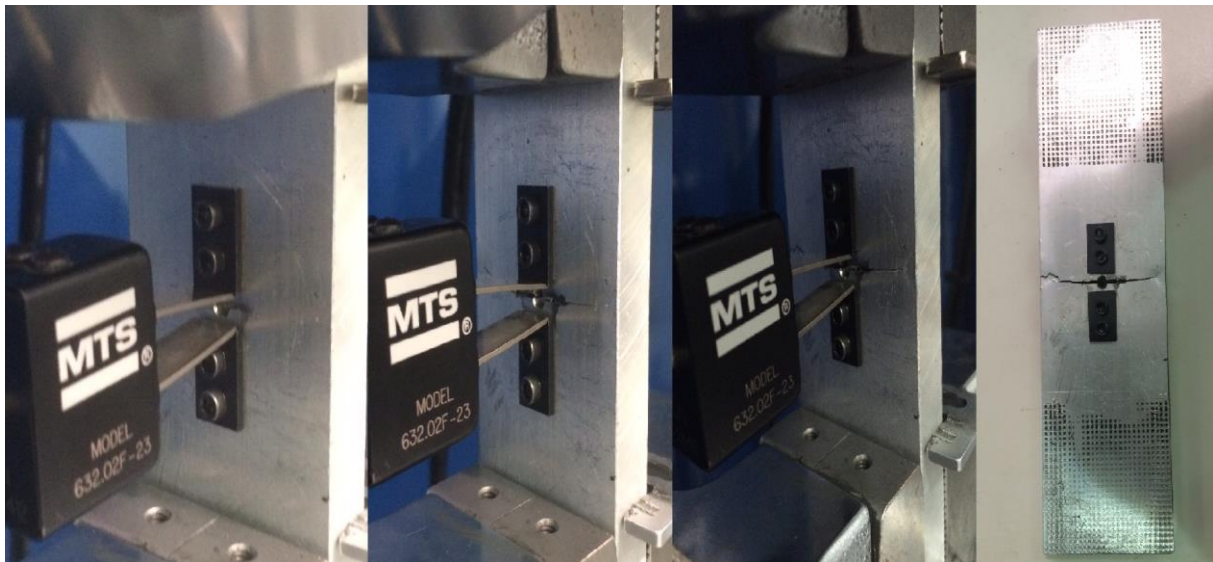
Figura 34- Desenvolvimento da trinca do corpo de prova 3
