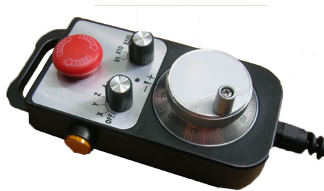
Figura 4.50: MPG Manual Pulse Generator [28]
