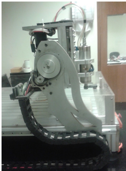
Figura 3.4: Coluna que sustenta a ponte do Eixo X
