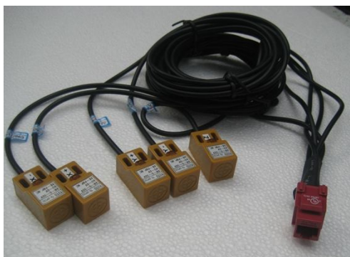
Figura 4.53: Kit de sensores indutivos [31]
