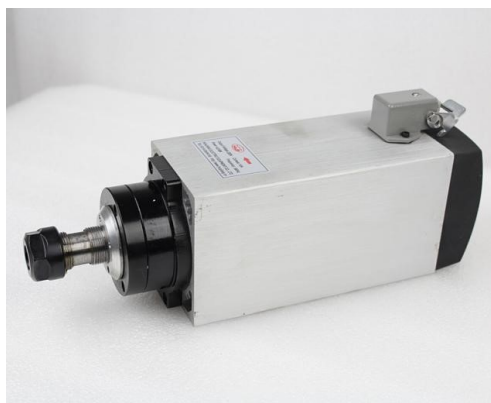
Figura 4.44: Spindle 3kW refrigerado a ar [16]
