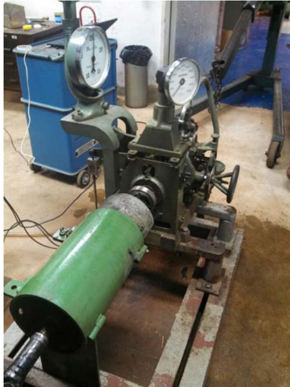
Figura 1.11 - Dinamômetro do laboratório de motores de combustão interna
