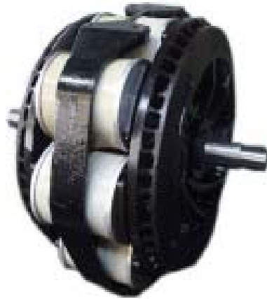
Figura 1.6 - Conjunto de bobinas de um dinamômetro de Foucault
