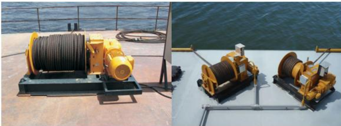
Figura 73 – Guincho de atracação e fundeio. (EKRON, 2015)
