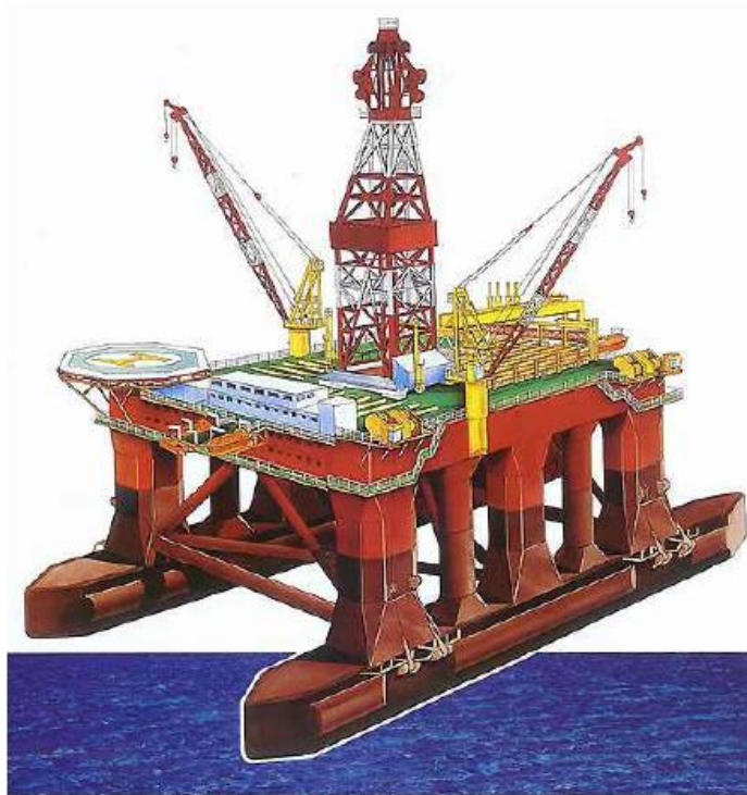
Figura 19 – Exemplo de plataforma semissubmersível. (MARTINEZ, 2014)
