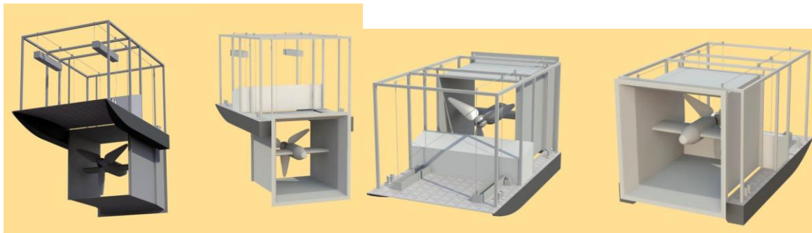
Figura 28 – Flutuador com içamento independente para difusor quadrado
