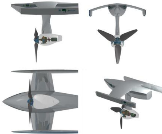
Figura 26 – Modelo “Enterprise” ou Conceção tipo flutuador com içamento externo. (GIRÃO e MIRANDA, 2012)
