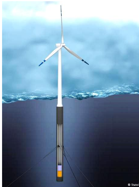
Figura 68 - A turbina eólica com seu lastro de cimento sustentada por cabos. (GROTELÜSCHEN e FRANÇA, 2013)
