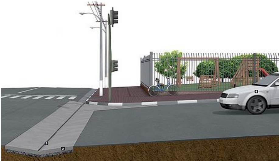
[Figura 22. Exemplo esquemático de sarjetão em cruzamento]
