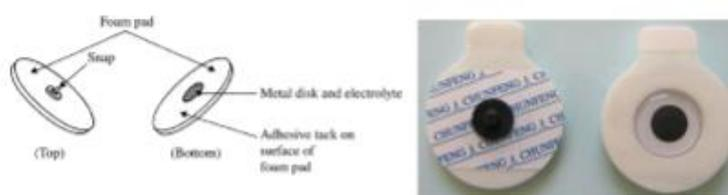
Figura 6 - Eletrodos de superfície utilizados na aquisição do sinal de ECG.
