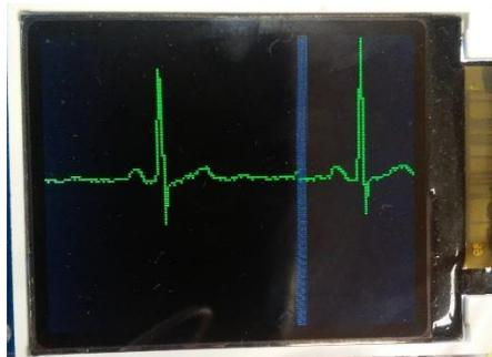
Figura 22 – Visualização do *display* com ECG implementado.
