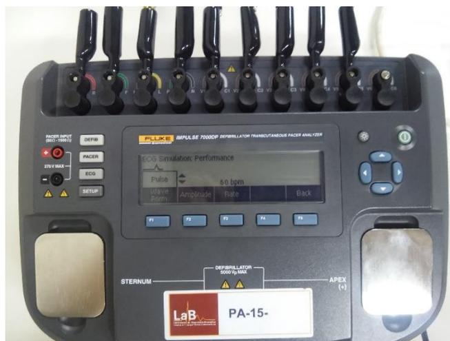
Figura 25 – Aparelho utilizado para fazer o teste de desempenho, modelo IMPULSE 7000DP, marca FLUKE.
