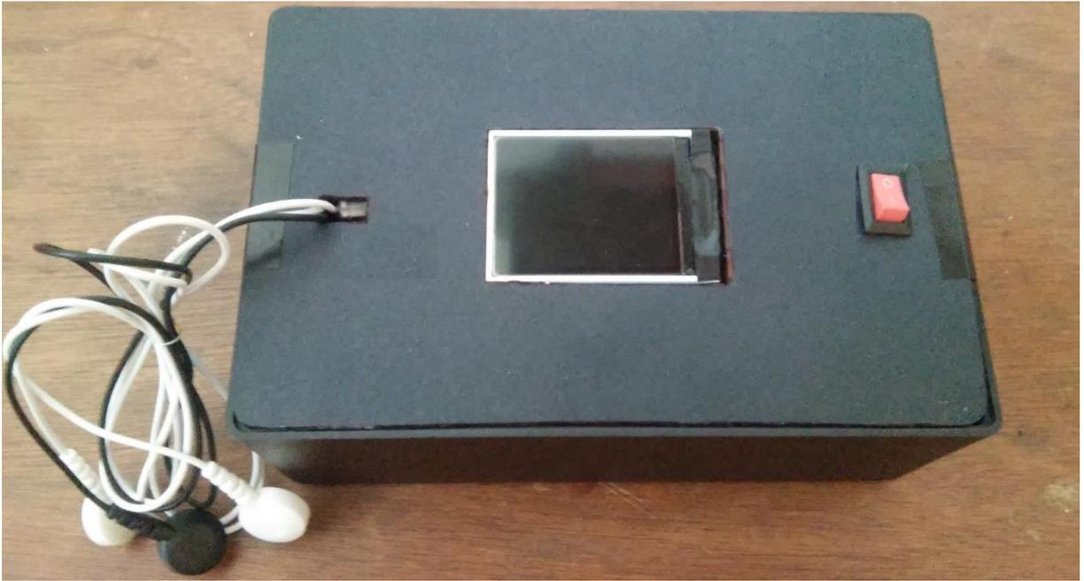
Figura 23 – Visão frontal do protótipo do ECG portátil.
